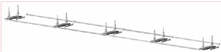
Чертеж 2.32б – Этап 2 – Наложение начальных элементов
